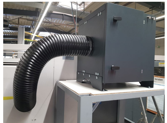
AL-KO OIL JET 600 an einem Bearbeitungszentrum
