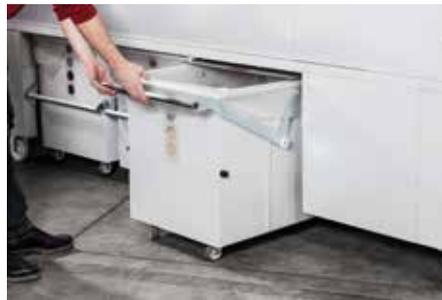
Spänebehälter wieder einsetzen und Staubschott entfernen
